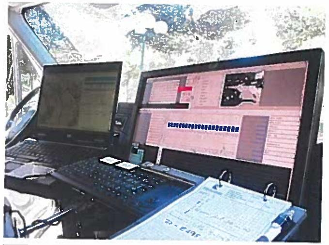
Figura 3 Equipamento embarcado em veículo de recolha de dados para o sistema de gestão de pavimentos da Infraestruturas de Portugal
