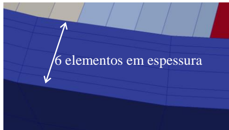
Figura 9. Discretização corpo barragem: 6 elem. em espessura
