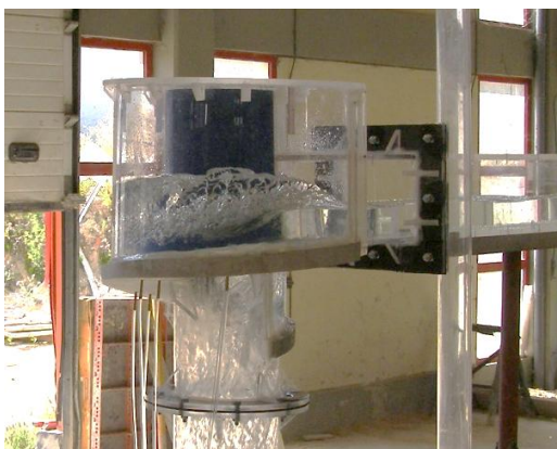
Figura 2. Escoamento no canal de entrada de caudal e câmara de vórtice ( 10 \text{ m}^3/\text{s} )
