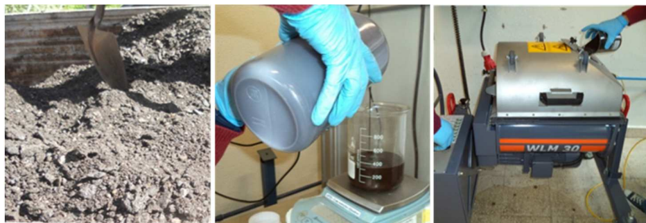
Figura 3.3 – Fabrico em laboratório de mistura reciclada incorporando material fresado e emulsão betuminosa, em misturadora específica para a produção a frio (com emulsão ou espuma de betume)
