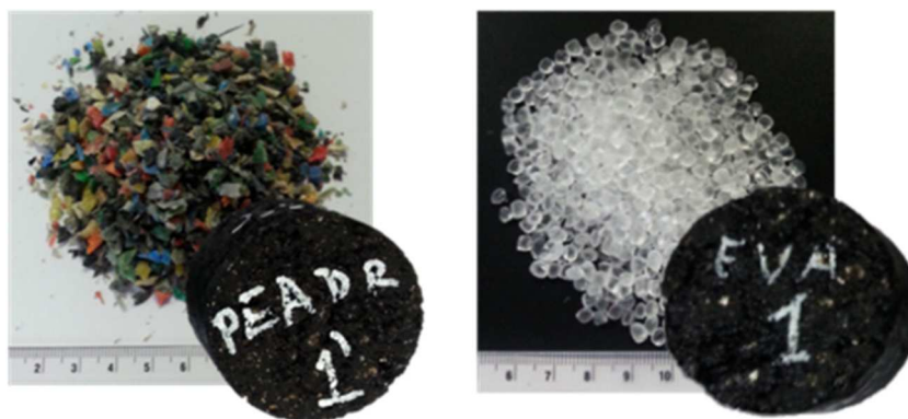
Figura 3.2 – Provetes em mistura betuminosa incorporando plásticos reciclados do tipo Polietileno de alta densidade (PEAD) e Etileno-acetato de vinilo (EVA)
