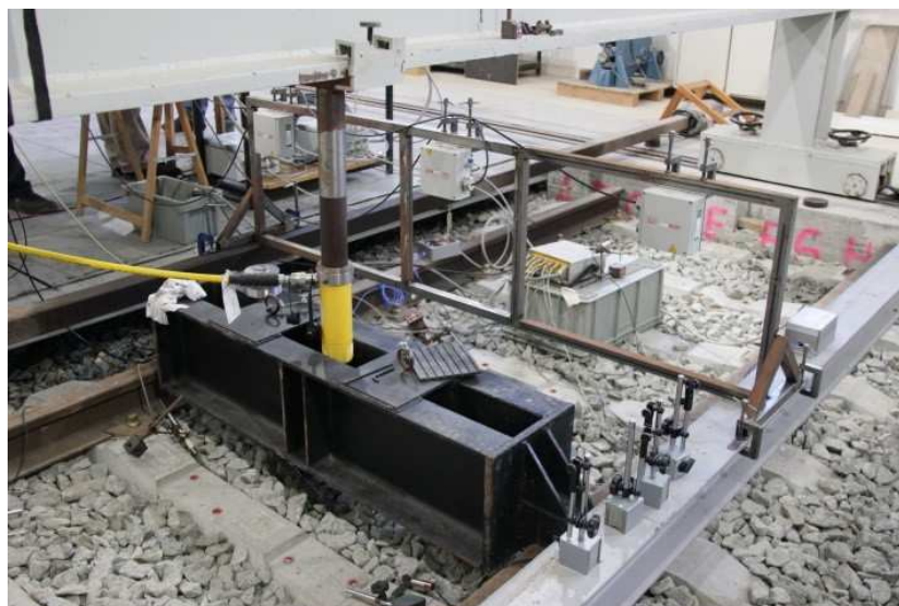
Figura 3.4 – Aspeto dos ensaios de carga cíclica no modelo físico da via-férrea à escala real (Projeto GroutRail)
