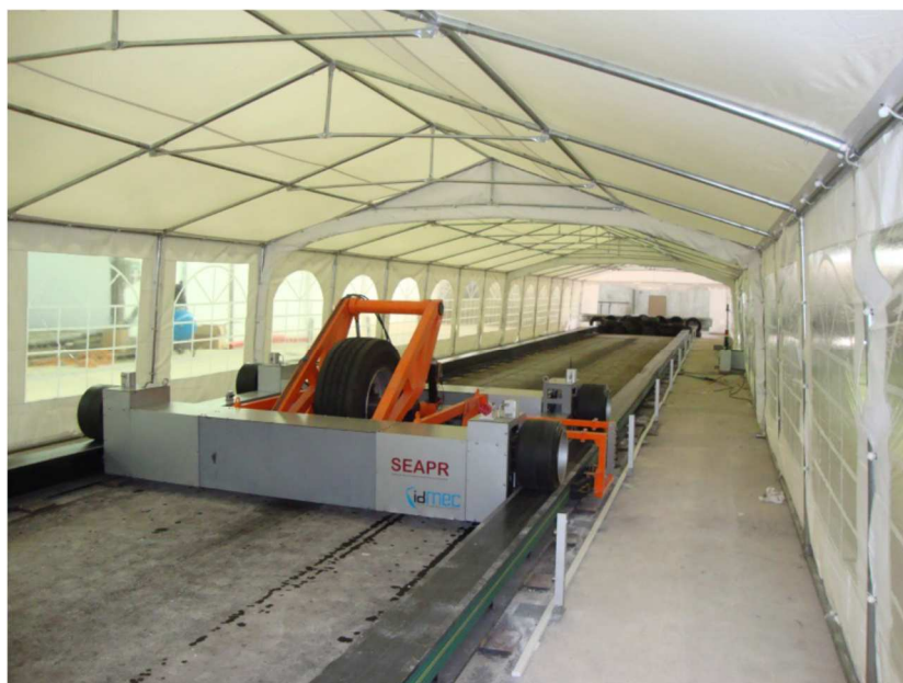
Figura 3.6 – Simulador de ensaios acelerados sobre pavimentos rodoviários
