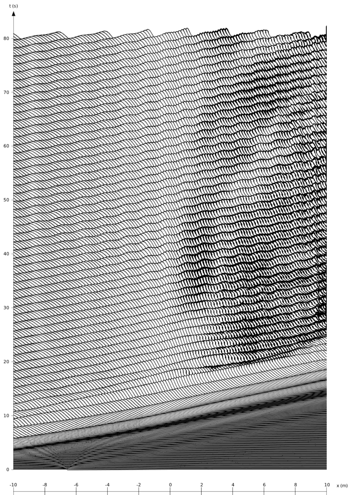
Figura 12. Gráfico do tipo waterfall , que relaciona a elevação de superfície livre da onda, com a posição ao longo do canal e com o tempo.
