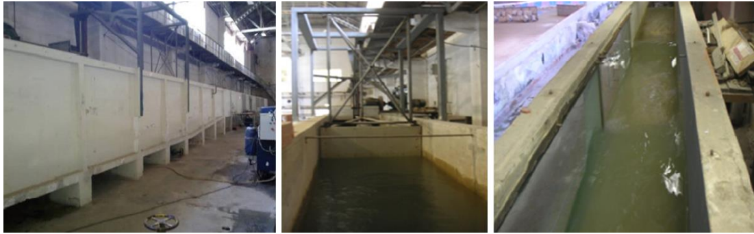
Figura 1. Vista lateral do canal (esquerda), gerador de ondas (centro) e vista de cima do canal (direita).
