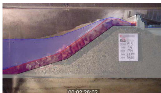
Figura 35. Imagem captada no ensaio num instante em que se registou a ocorrência de galgamento e sobreposição com os resultados do modelo SWASH para o mesmo instante
