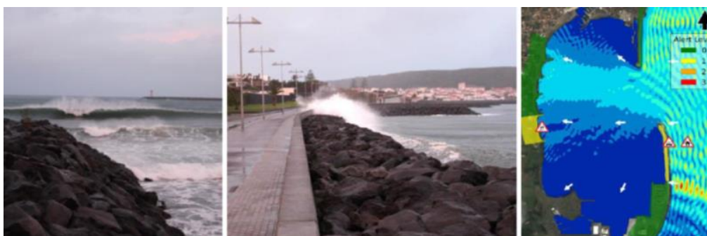
Figura 23. Estado do mar e galgamento na baía da Praia da Vitória a 14 de dezembro de 2015. A figura da esquerda e do centro foram tiradas pelas 18h30 no sector sul da defesa frontal da baía. O HIDRALERTA emitiu um alerta amarelo (galgamentos de pequenas dimensões e consequências reduzidas) pelas 18h00 (direita).
