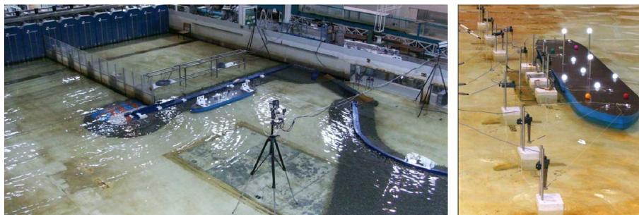
Figura 2 –Modelo físico do navio petroleiro amarrado à estrutura de acostagem. 2.<sup>a</sup> fase do estudo. Retirado de Rosa-Santos (2010).
