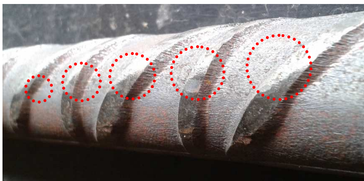
Figura 3. Deformações permanentes sofridas pelas nervuras transversais de um varão durante o seu processo de endireitamento.
