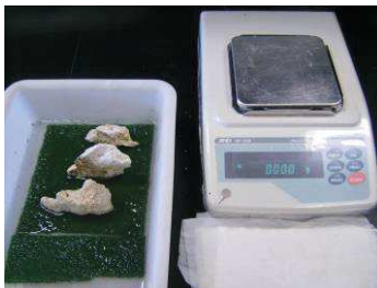
Figura 6: Pormenores do ensaio de absorção de água por capilaridade, nos Laboratórios da Universidade de Aveiro.
