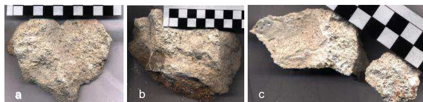
Figura 5: Amostras de argamassas do Cais das Colunas: a - MO1; b - MO2; c - MO3.
