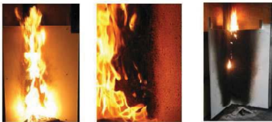
Figura 8.3 – Imagens extraídas durante as diferentes fases de um ensaio de reação ao fogo em produtos biocompósitos, gentilmente cedidas pelo Eng o Carlos Pina dos Santos (LNEC)
