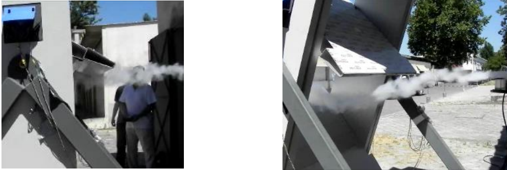
Figura 10 – Visualização do escoamento com injeção de fumo para \alpha = 30^\circ , à direita, e \alpha = 50^\circ , à esquerda.
