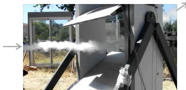
Figura 9 – Visualização do escoamento com injeção de fumo para \alpha = 30^\circ . As setas assinalam a direcção do fumo a montante e a jusante da cascata.
