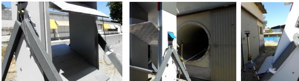
Figura 4 – Pormenor do modelo seccional, saída do túnel de vento de jato livre do LNEC e anemómetro de ultra-sons 2D.
