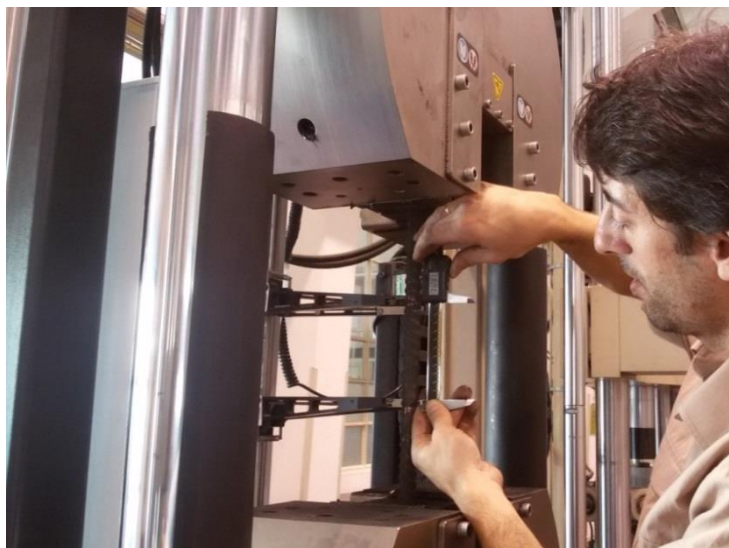
Fig. 9 – Medição com paquímetro da extensão permanente na força máxima de ensaio
