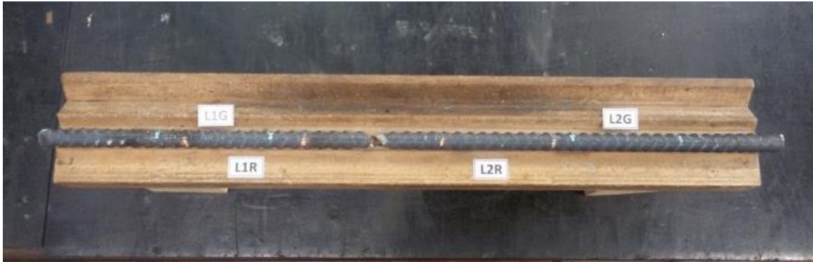
Fig. 8 – Identificação das zonas de medição da extensão permanente na força máxima
