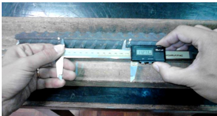
Figura 3: Medição do comprimento final entre referências, L'_u , após a rotura do provete.
