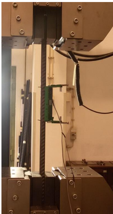
Figura 1: Colocação de um extensómetro no varão para determinação da extensão total na força máxima, através do ensaio de tração.
