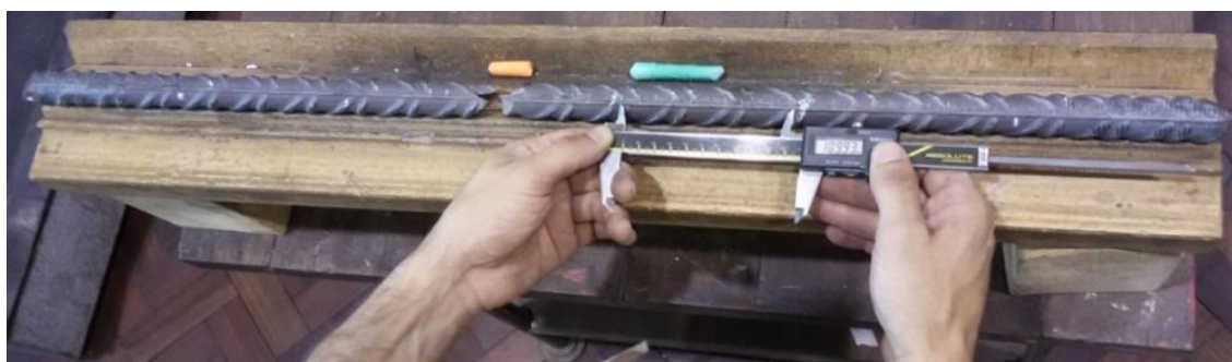
Figura 2: Medição do comprimento final após rotura recorrendo à utilização de um paquímetro
