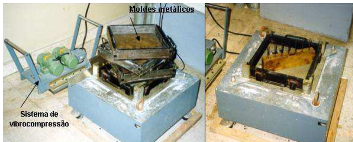
Figura 5.11 – Aspecto do sistema de compactação laboratorial das latejas para ensaio de simulação em pista de laboratório
