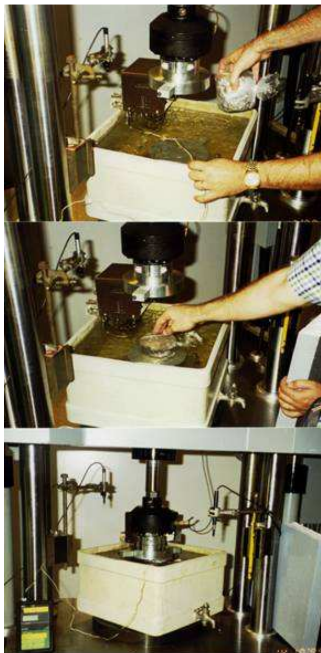
Figura 5.2 – Várias fases da imersão em água do provete para realização do ensaio de compressão uniaxial de cargas repetidas
