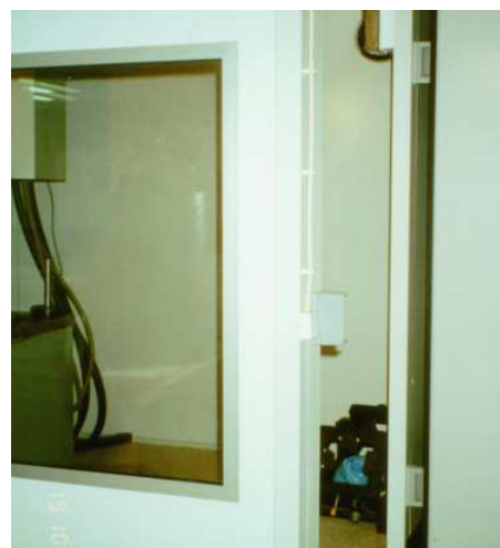
Figura 5.1 – Aspecto da câmara de temperatura controlada colocada à volta do equipamento servo-hidráulico
