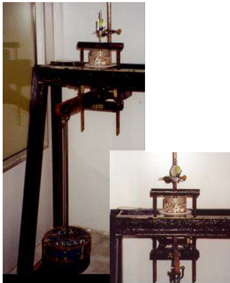
Figura 4.4 – Aspecto da montagem realizada para o ensaio de compressão uniaxial estático
