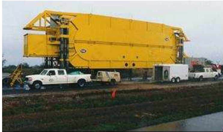
Figura 4.31 – Texas Mobile Load Simulator – Estados Unidos
