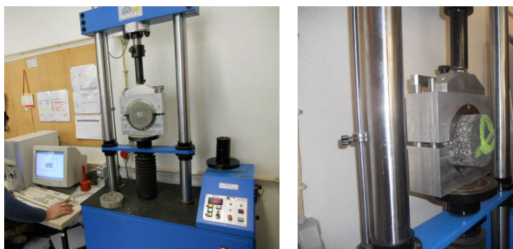
Figura 2: Aspeto do equipamento utilizado no ensaio de Leutner modificado e de provete em ensaio
