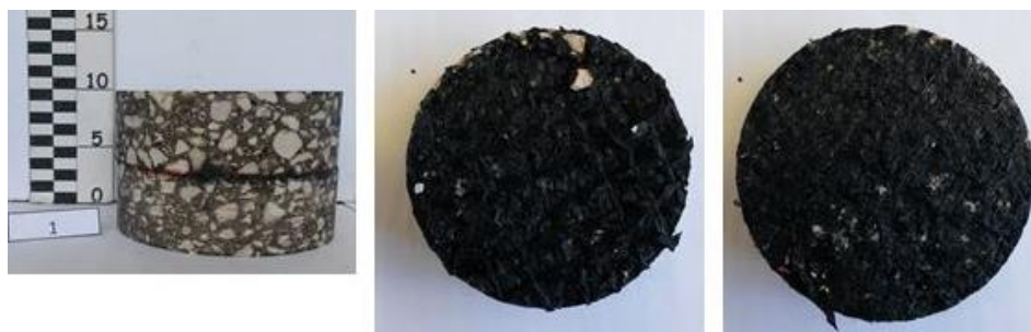
Figura 3: Aspeto do provete após ensaio e da interface entre camadas
