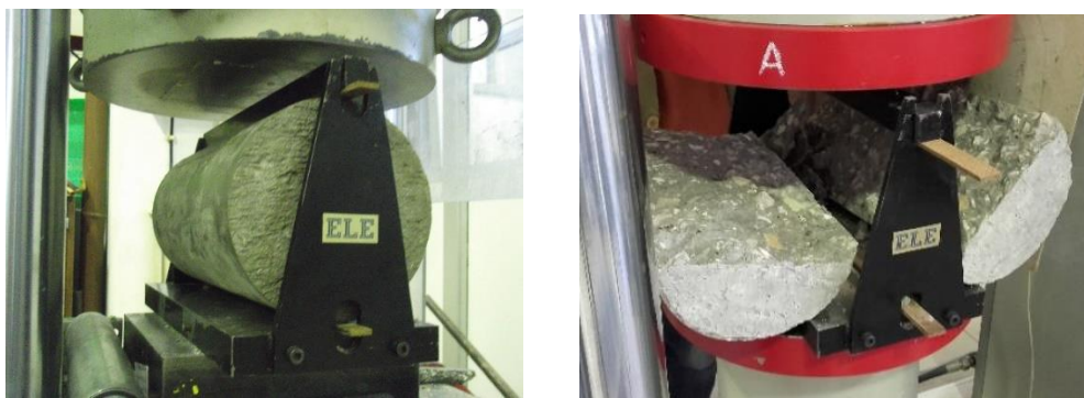
Figura 10: Ensaio de resistência à tração por compressão diametral (antes e após a rotura).
