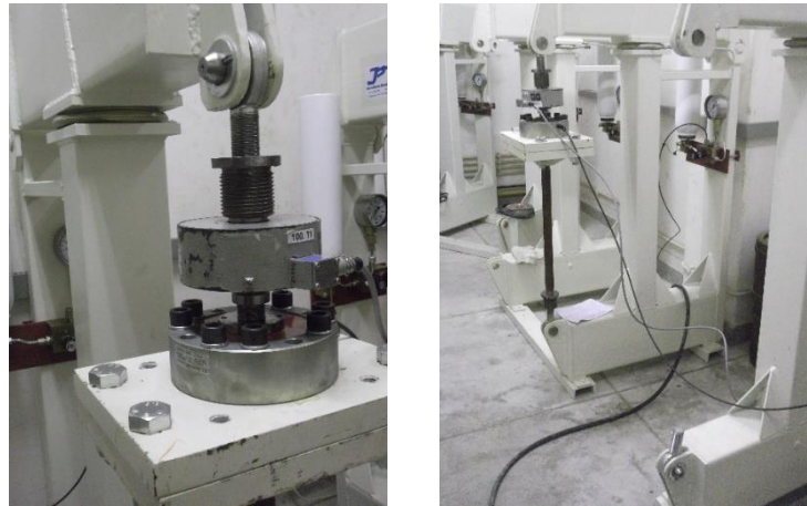
Figura 3: Calibração dos transdutores de força.
