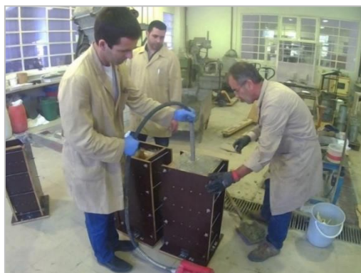
Figura 5: Moldagem de um provete do tipo bone shaped para o ensaio de fluência em tração (LNEC-NBPC, maio de 2016).
