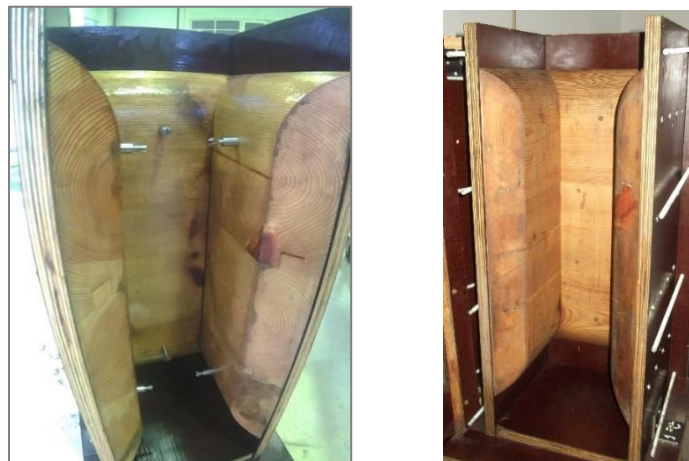
Figura 4: Molde de madeira para moldagem de provete do tipo bone shaped e pormenor do tipo de pernos para colocação dos LVDT 's.
