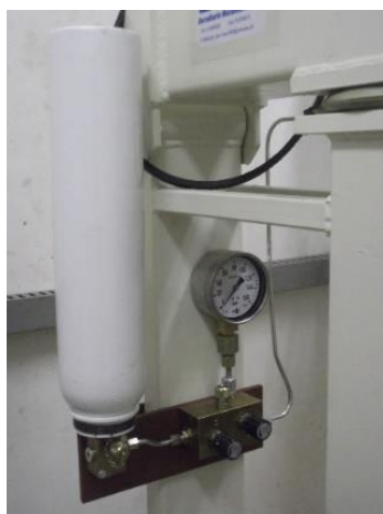
Figura 2: Acumulador com interface óleo-gás, manómetro e válvulas do circuito óleo-hidráulico.
