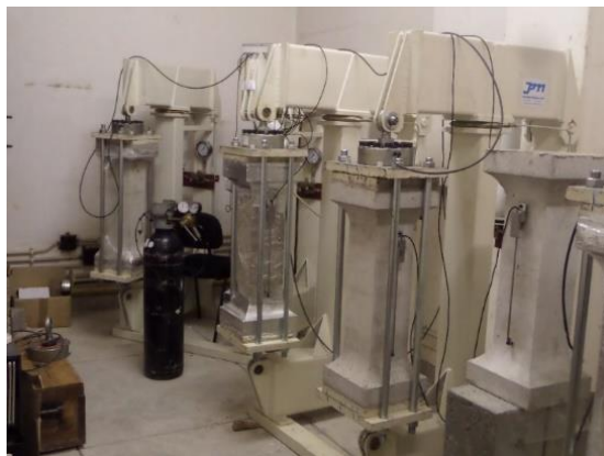
Figura 1: Sistema de alavancas para ensaios de fluência em tração de provetes de betão [Oliveira, 2002; Emílio et al. 2007]
