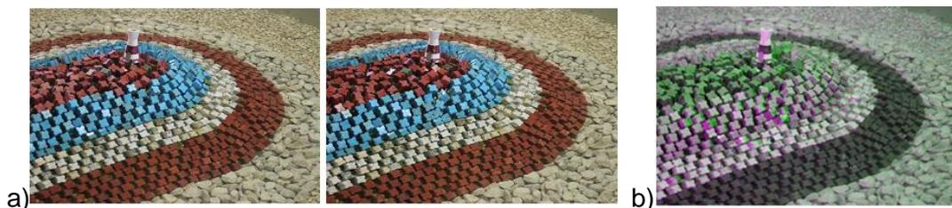
**Fig. 7. a) Imagens obtidas no final de dois ensaios tridimensionais consecutivos; b) Imagem resultante da comparação das imagens (Rodrigues, 2014; Lemos et al. 2014)**
