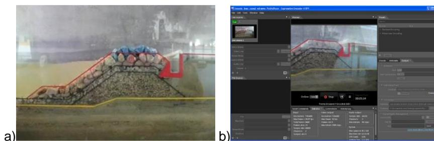
**Fig. 8. a) Visualização de um ensaio em tempo real através de *image streaming*; b) Acesso remoto para visualização da aquisição de dados durante os ensaios (Capitão et al. 2014)**
