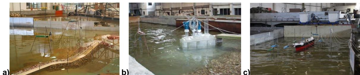
**Fig. 1 – Modelos físicos: a) Agitação, estabilidade e galgamentos, Poças, Açores; b) Comportamento hidráulico de dispositivo de energia das ondas; c) Comportamento de navios**
