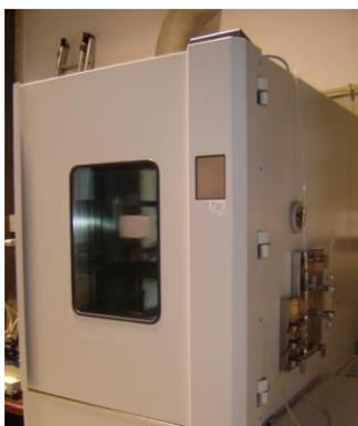
Figura 2: Camara de testes de emissão existente no LNEC
