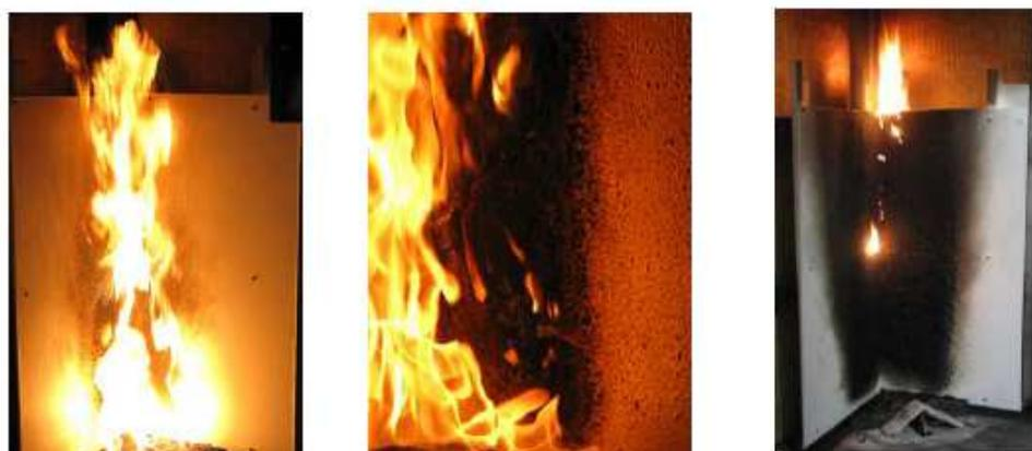
Figura 3: Imagens extraídas durante as diferentes fases de um ensaio de reação ao fogo em produtos biocompósitos, gentilmente cedidas pelo Eng<sup>o</sup> Carlos Pina dos Santos (LNEC)
