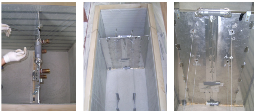
Figura 7. Instalação da cortina e dos tirantes após colocação de solo até à altura de 80 cm.
