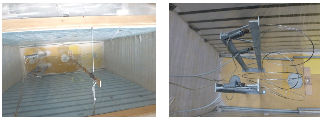
Figura 6. Vista dos montantes, dos tirantes e da ripa no interior do contentor ainda vazio.
