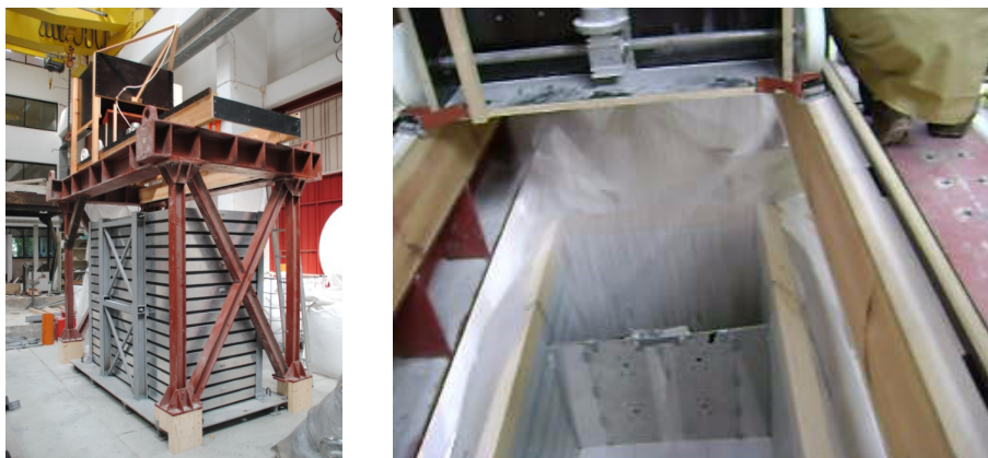
Figura 2. Vista do chuveiro de areia sobre o contentor e imagem de preparação do maciço por chuva de areia.
