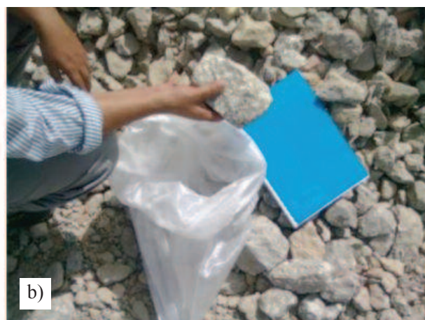
Fig. 2 – Amostragem do AB RCD : a) pilha de material; b) recolha de um bloco.
