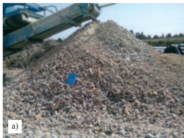
Fig. 2 – Amostragem do AB RCD : a) pilha de material; b) recolha de um bloco.
