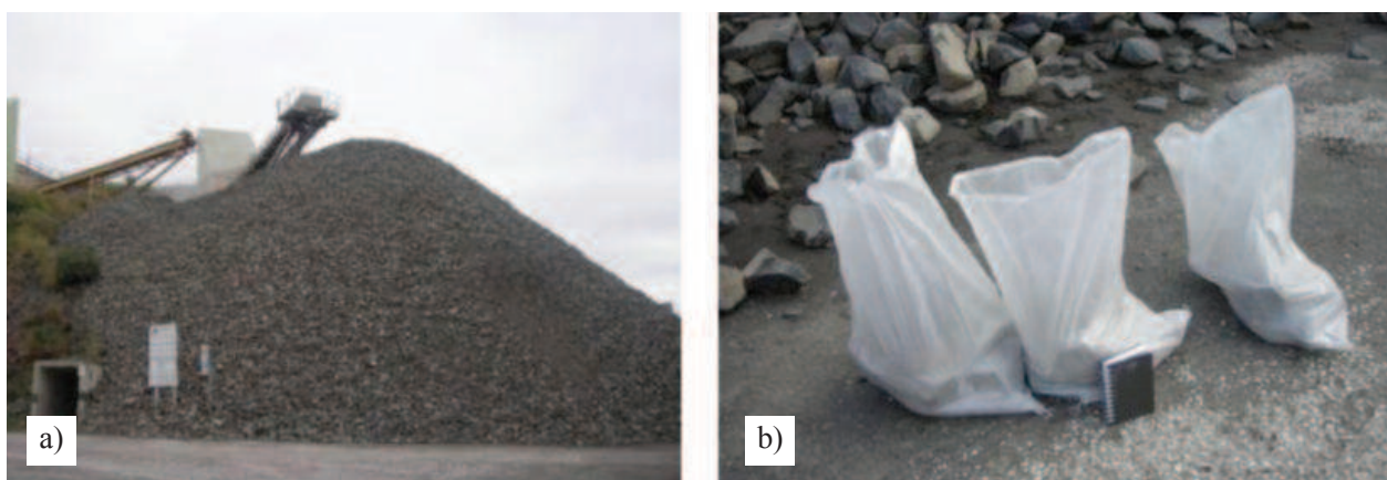
Fig. 4 – Amostragem do BAS: a) pilha de material pré-britado; b) amostra recolhida.
