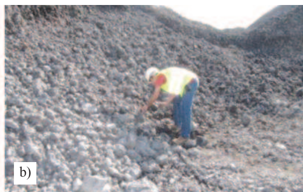
Fig. 3 – Amostragem do ASIC: a) pilha de material; b) recolha da amostra.
