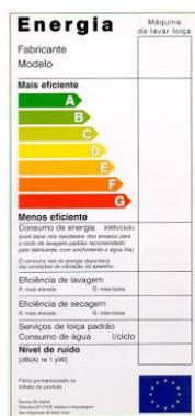
Figura 24 – Modelo de rótulo energético para máquinas de lavar loiça de acordo com a EN 50242
