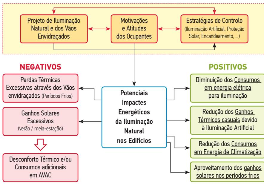
Figura 1 – Diagrama esquemático ilustrativo dos principais impactos energéticos da iluminação natural nos edifícios
