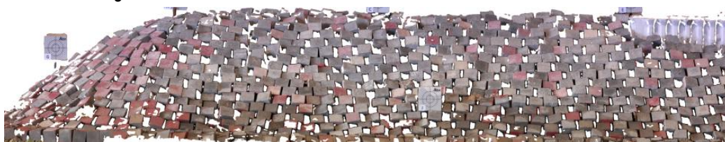
Figura 7 – Ortomosaico frontal de um modelo de um molhe obtido de fotografias terrestres criado pelo software Micmac
