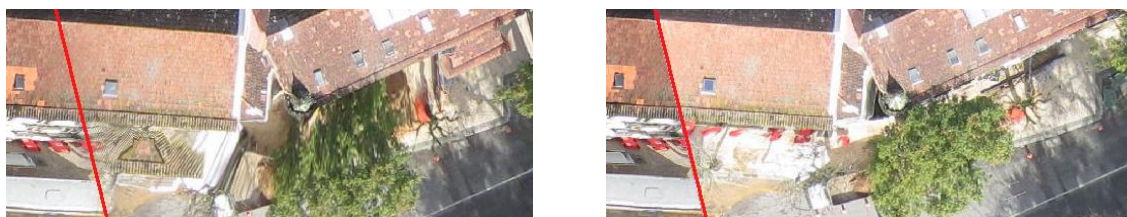
Figura 13 – Pormenor do ortomosaico, criado por junção de áreas das ortofotos A e D, e a hipótese de este resultar da junção de áreas das ortofotos A e E
