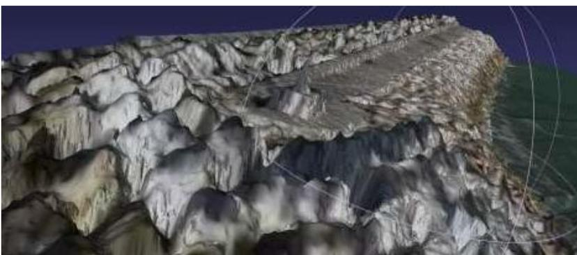
**Figura 5** – Ortomosaico sobre o MDS. No centro, ao longo do molhe, a superestrutura em betão. Na extremidade mais próxima, no centro de uma zona circular, o farolete instalado sobre uma base em betão
