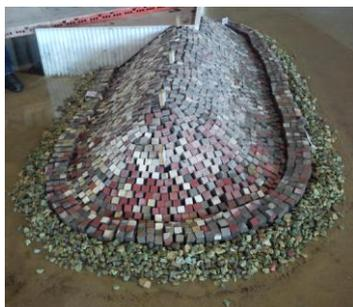
Figura 7 – Modelo físico do molhe
