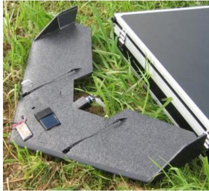
**Figura 1** – VANT asa fixa: Swinglet da senseFly
