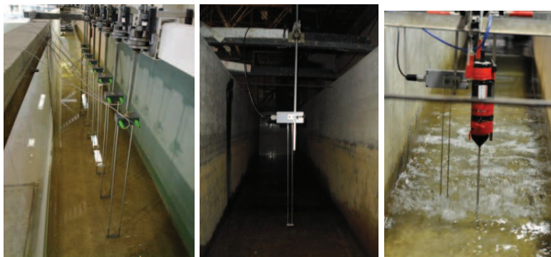
Figura 3. Conjunto de 8 sondas de nível (esquerda), sonda de nível junto ao batedor (centro) e sondas ADV e de nível (direita).
