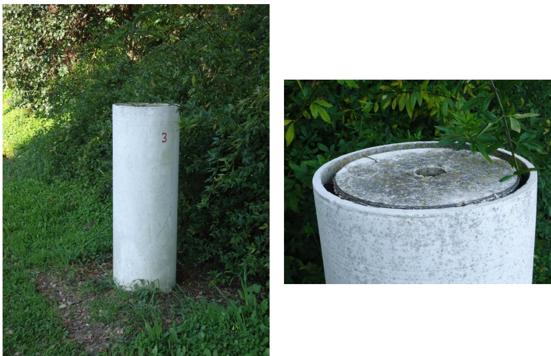
Figura 3.2 – Pilar de estacionamento (P3) da base de teste do LNEC (à esquerda). Topo do pilar (P3) com a peça de centragem forçada do tipo Wild (à direita).
