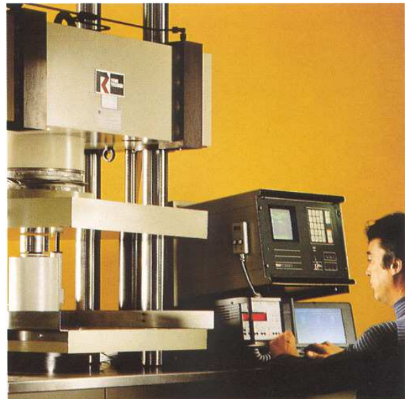
Figura 1 – Verificação do sistema de medição de forças de máquinas de ensaio pelo LMF/LNEC
