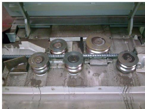
Figura 2. Aspeto de uma fase final do endireitamento de varões produzidos em rolo.
