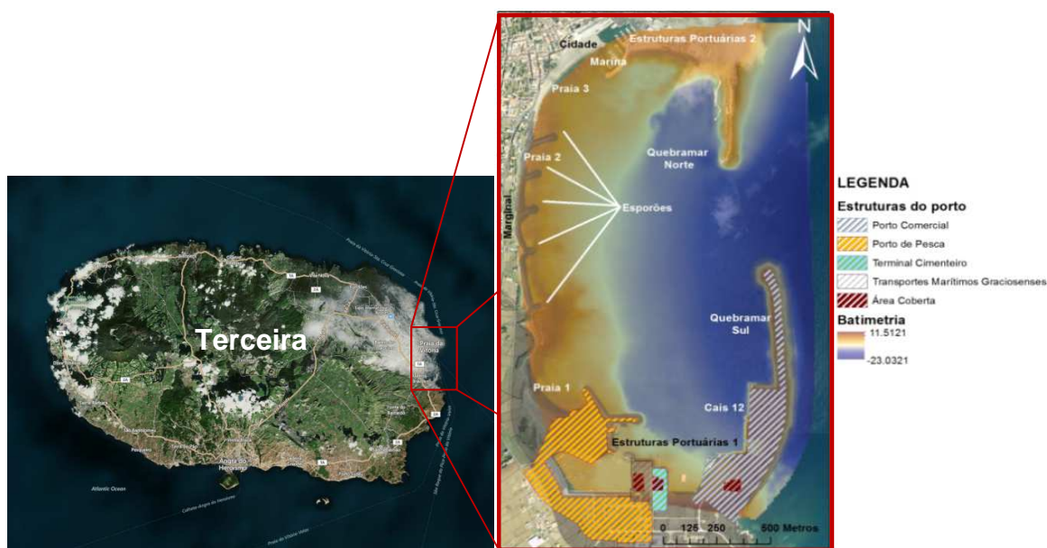
Figura 6. Porto e baía da Praia da Vitória. Estruturas marítimas existentes.
