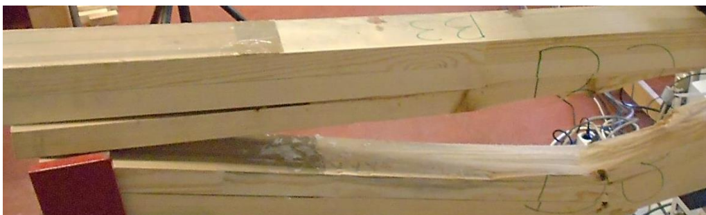
Figura 5. Presença de fita-cola entre lamelas
