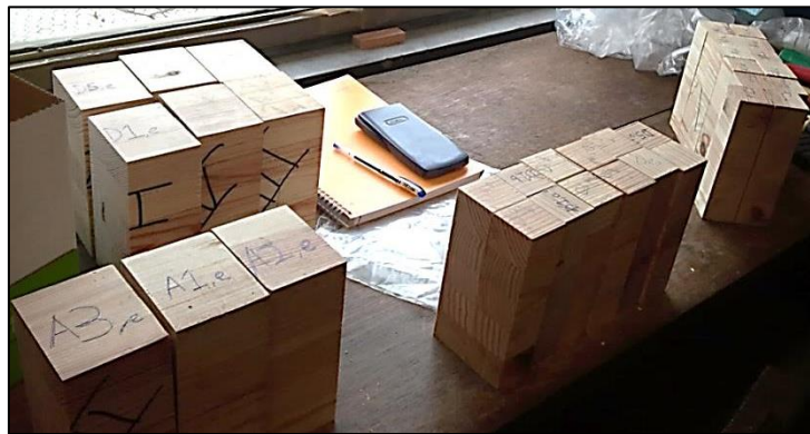
Figura 6. Provetes utilizados em ensaios de delaminação e de corte
