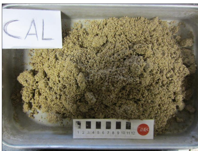
Figura 6.128 – Aspeto do material CAL/areia após o ensaio de permeabilidade com o lixiviado
