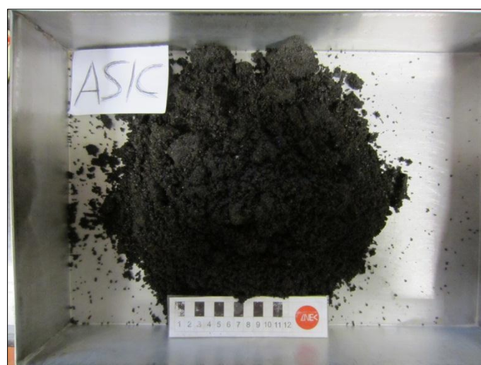
Figura 6.17 – Aspeto do material ASIC/areia após o ensaio de permeabilidade com o lixiviado
