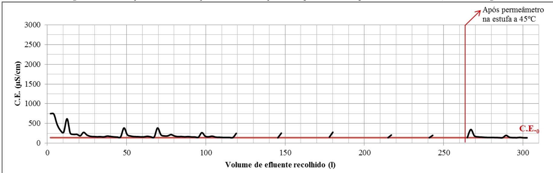
Figura 6.61 – Variação da C.E. da solução efluente em função do volume recolhido no ensaio de permeabilidade do AB RCD /brita com água
