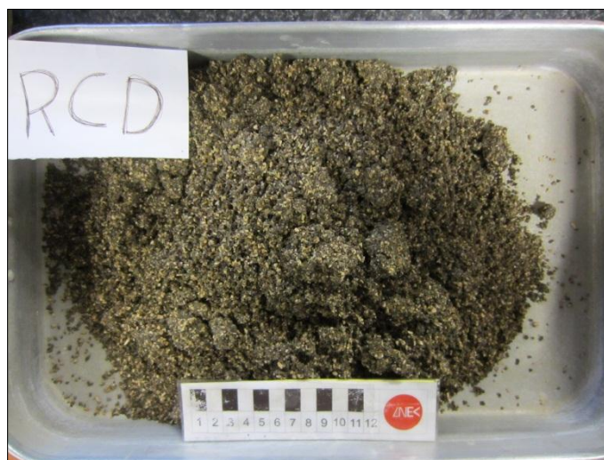
Figura 6.54 – Aspeto do material AB RCD /areia após o ensaio de permeabilidade com o lixiviado
