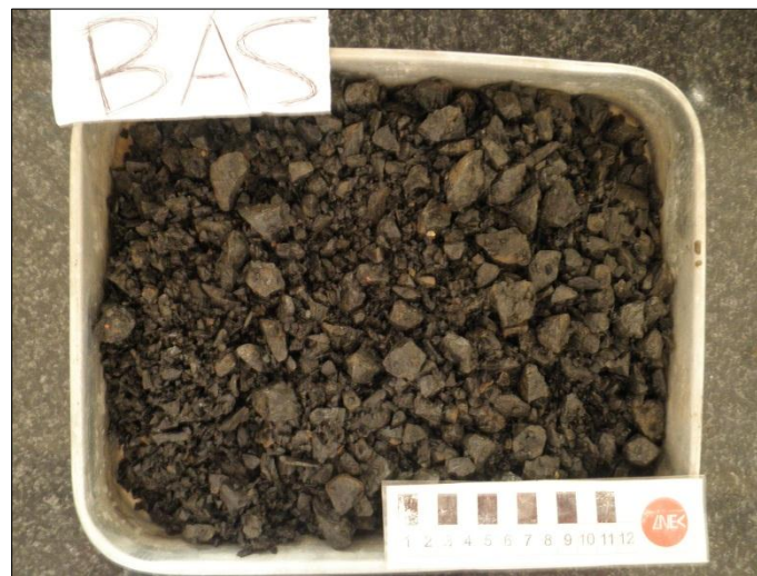
Figura 6.100 – Aspetto do material BAS/brita após o ensaio de permeabilidade com água
