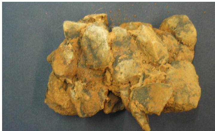
Figura 2.13 – Colmatação de material granular de uma camada de drenagem de um aterro de resíduos (Brune et al., 1991, citado em Marshall e Fleming, s/d)
