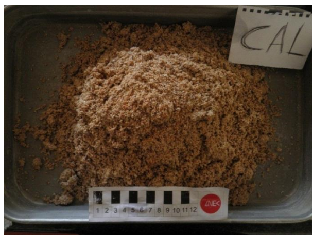
Figura 6.119 – Aspeto do material CAL/areia após o ensaio de permeabilidade com água
