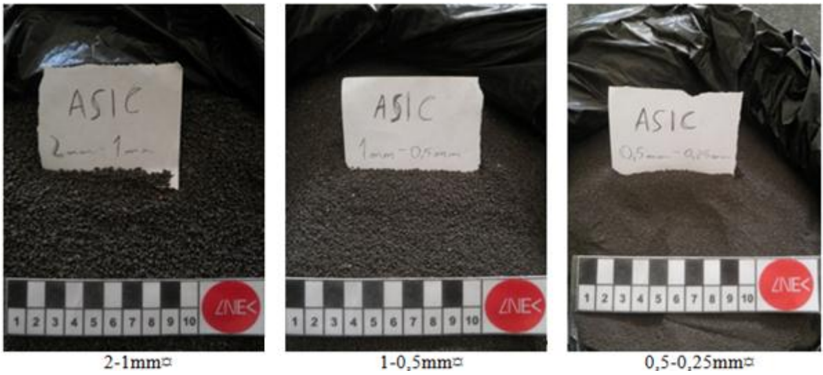
Figura 5.20 – Frações granulométricas do ASIC/areia
