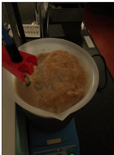
Figura 5.26 – Formação de espuma na superfície do lixiviado em reação à adição da solução de HCl
