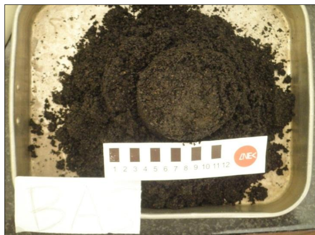
Figura 6.82 – Aspeto do material BAS/areia após o ensaio de permeabilidade com água
