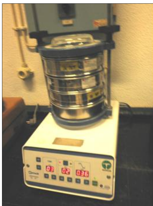
Figura 5.19 – Peneiração das frações granulométricas necessárias para a construção dos provetes
