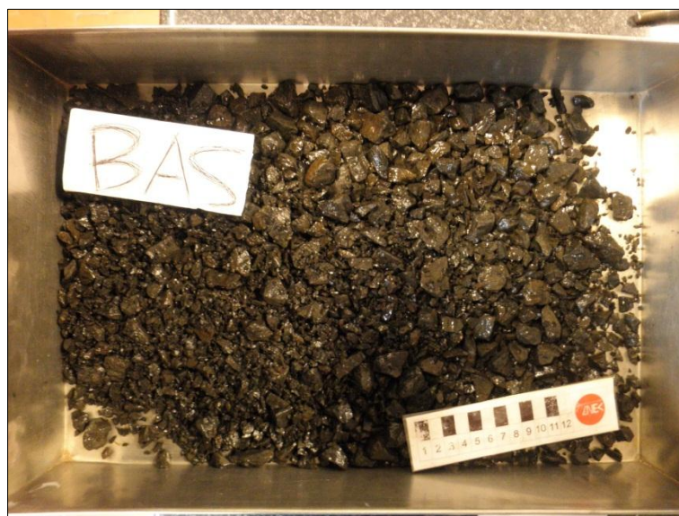
Figura 6.109 – Aspetto do material BAS/brita após o ensaio de permeabilidade com o lixiviado
