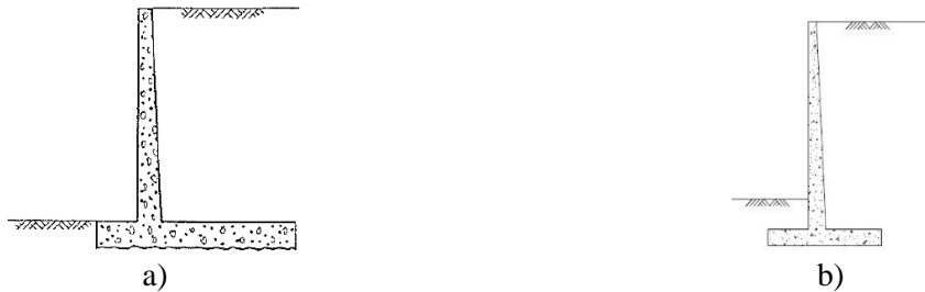
Figura 2.37 – Muro de consola: a) tipo L (Matos Fernandes, 1995); e b) tipo T invertido (Vinevala, 2011)
