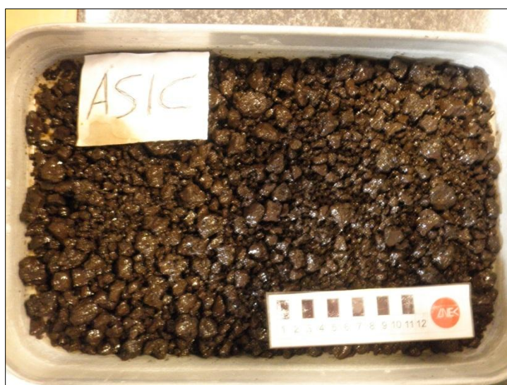
Figura 6.35 – Aspeto do material ASIC/brita após o ensaio de permeabilidade com o lixiviado
