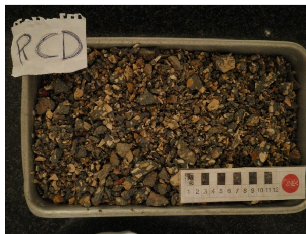
Figura 6.63 –Aspetto do material AB RCD /brita após o ensaio de permeabilidade com água
