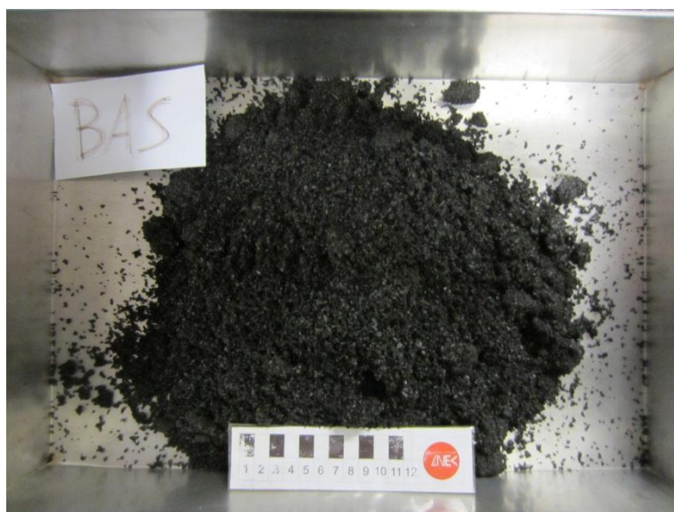
Figura 6.91 – Aspecto do material BAS/areia após o ensaio de permeabilidade com o lixiviado
