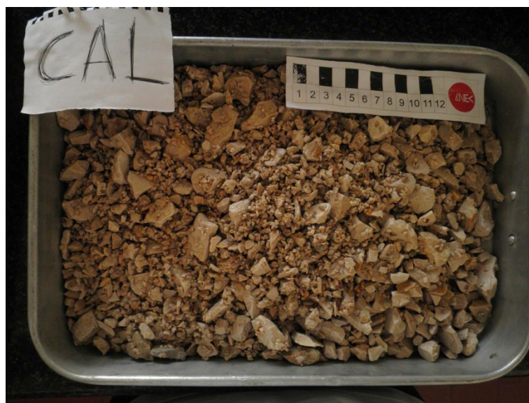
Figura 6.137 – Aspetto do material CAL/brita após o ensaio de permeabilidade com água
