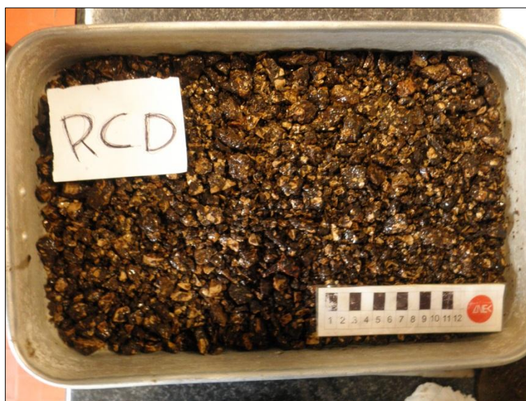
Figura 6.72 – Aspeto do material AB RCD /brita após o ensaio de permeabilidade com o lixiviado
