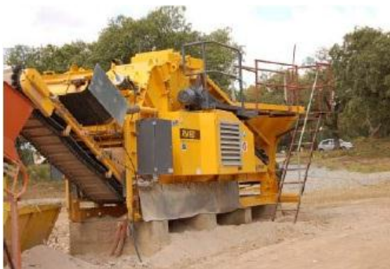
a) Tipo de equipamento utilizado na britagem do RCD (adaptado de Algarvio, 2009)
