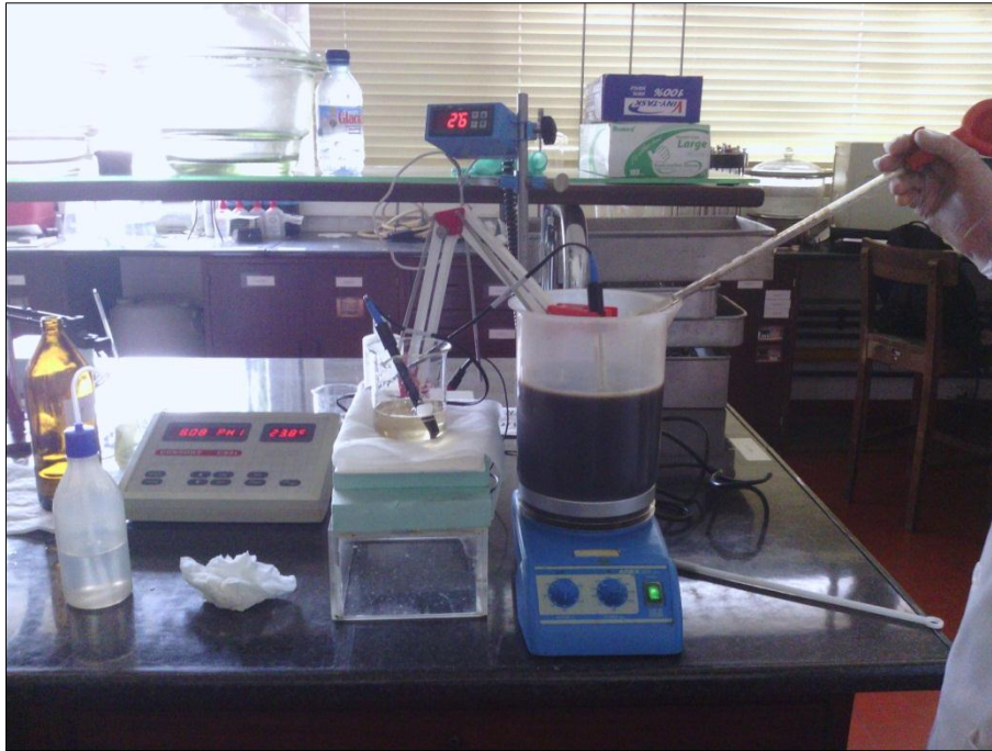
Figura 5.32 – Leituras da C.E. e do pH da solução de percolação (lixiviado) com o aparelho Consort C831
