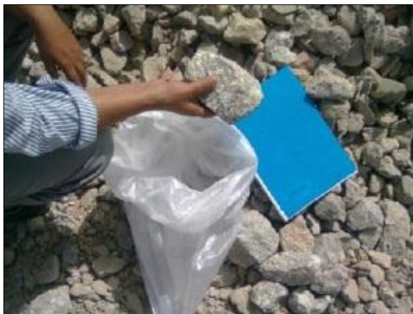
Figura 5.7 – Amostragem dos blocos de betão do RCD (Rodrigues, 2012)
