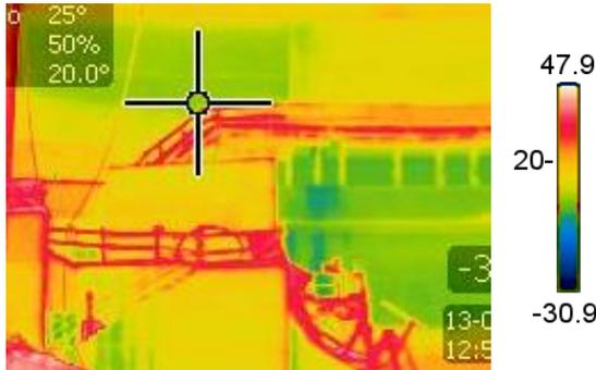
Figura 14. Uma das imagens do paramento (imagem original). Escala cromática com amplitude de 78.8°C.
