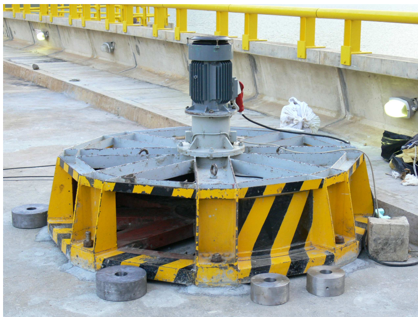
Figura 5 – Vista do vibrador de massa excêntrica colocado no local do ensaio
