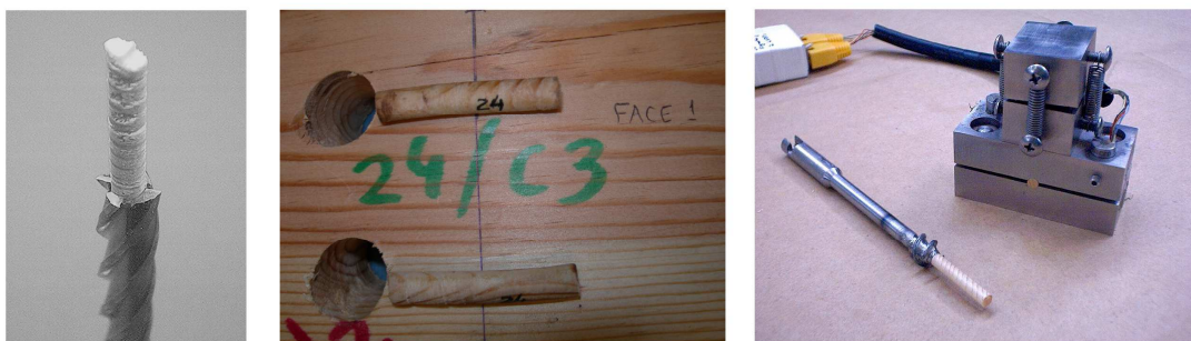
Figura 6. Dispositivo para ensaio de compressão axial de carotes [11]
