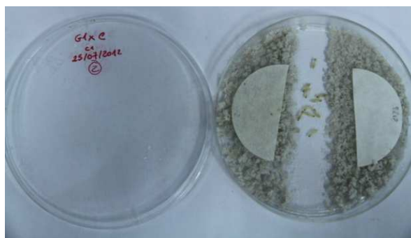
Figura 2. 8 - Ensaio de escolha entre extrato aquoso de madeira de pinho degradada por G. trabeum e controlo.
