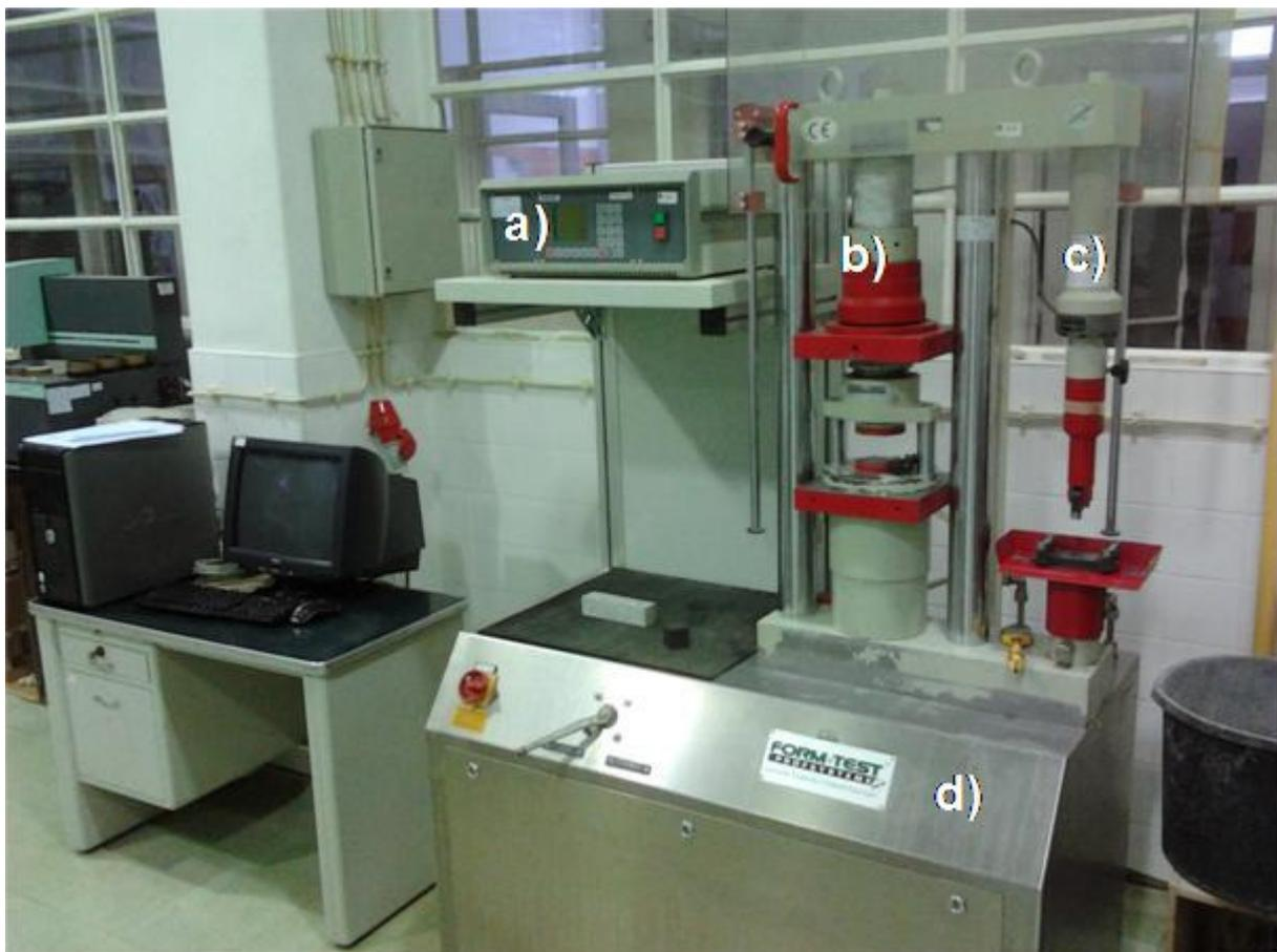
Fig. 1 Prensa hidráulica para ensaios de compressão e flexão dos laboratórios do NBPC: a) Unidade de comando e controlo; b) Atuador de compressão (200 kN); c) Atuador de flexão (10 kN); d) Unidade óleo-hidráulica.
