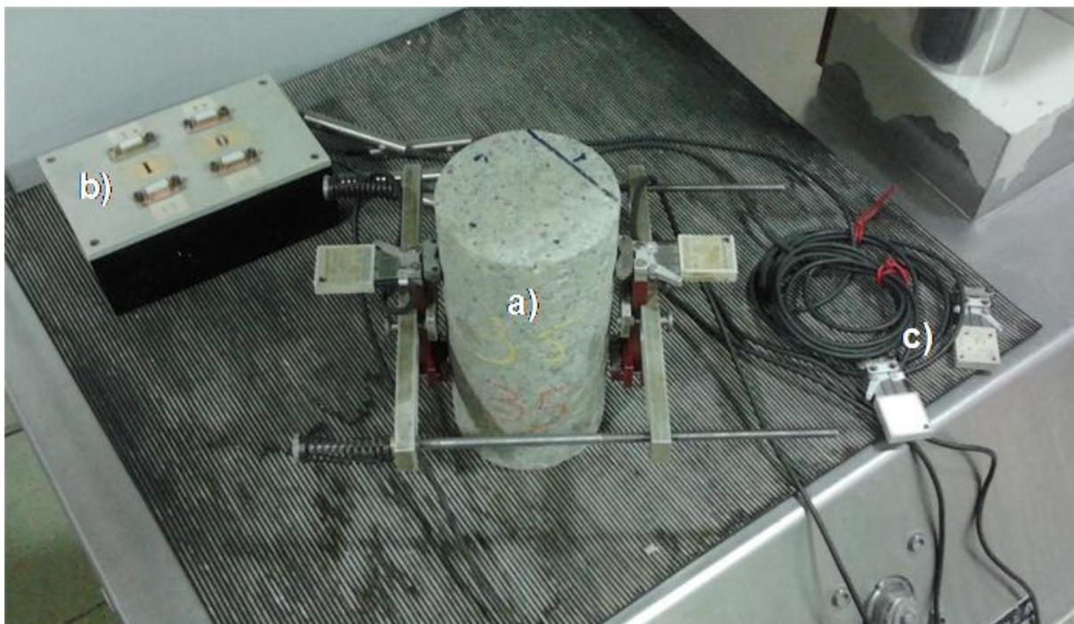
Fig. 3 Defómetros instalados no provete para ensaio: a) Provete cilíndrico de betão com dois defómetros instalados à sua superfície em zonas diametralmente opostas; b) Caixa concentradora dos defómetros; c) Defómetros de reserva não instalados.
