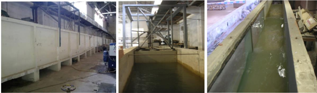
Figura 42 – Vista lateral do canal (à esquerda), gerador de ondas (ao centro) e vista de cima do canal (à direita).
