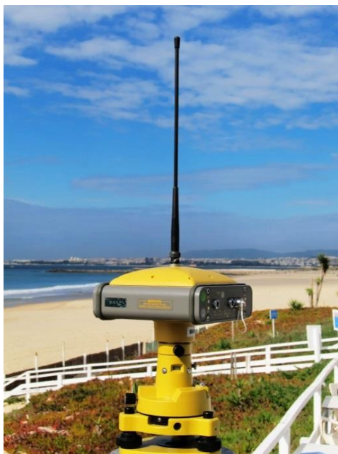
Figura 9: Aspectos dos levantamentos topo-batimétricos. a) Estrutura DGPS (BASE), b) Levantamentos no perfil PSJC3 (ROVER).
