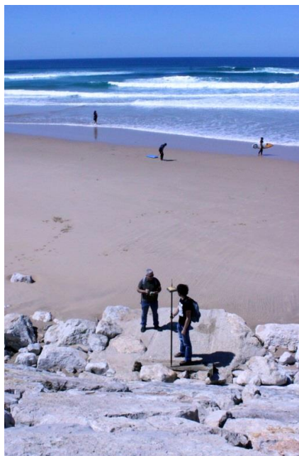
Figura 9: Aspectos dos levantamentos topo-batimétricos. a) Estrutura DGPS (BASE), b) Levantamentos no perfil PSJC3 (ROVER).
