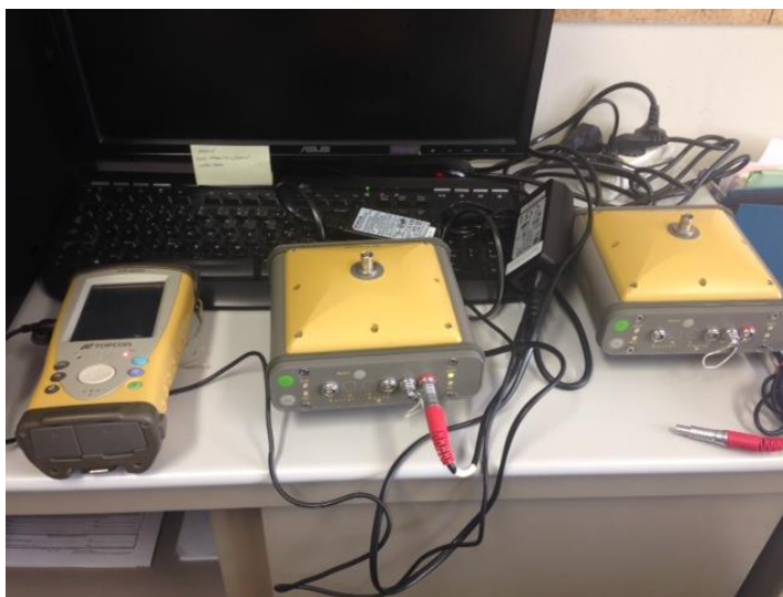
Figura 16: Recetores GPS (BASE e ROVER, ao centro e à direita) e controladora (à esquerda)
