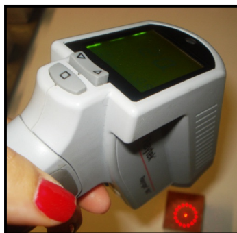
Figura 3.18 – Medição da emissividade efetuada com recurso a um pirómetro de IV.
