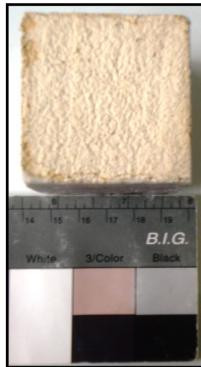
Figura 3.3 - Argamassa de cal aérea.
