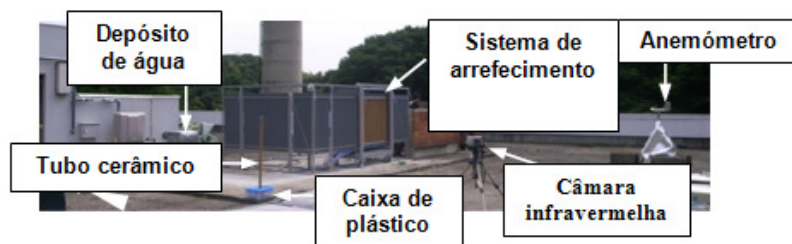
Figura 2.15 - Localização dos elementos integrantes do sistema de arrefecimento em estudo (He e Hoyano 2010).
