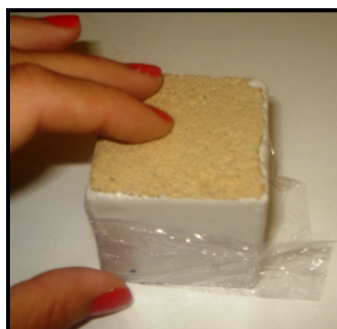
Figura 3.24 - Selagem dos provetes.
