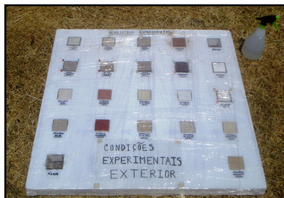
Figura 3.27 - Dispositivo experimental envolto pela folha de polietileno e o recipiente com a água.
