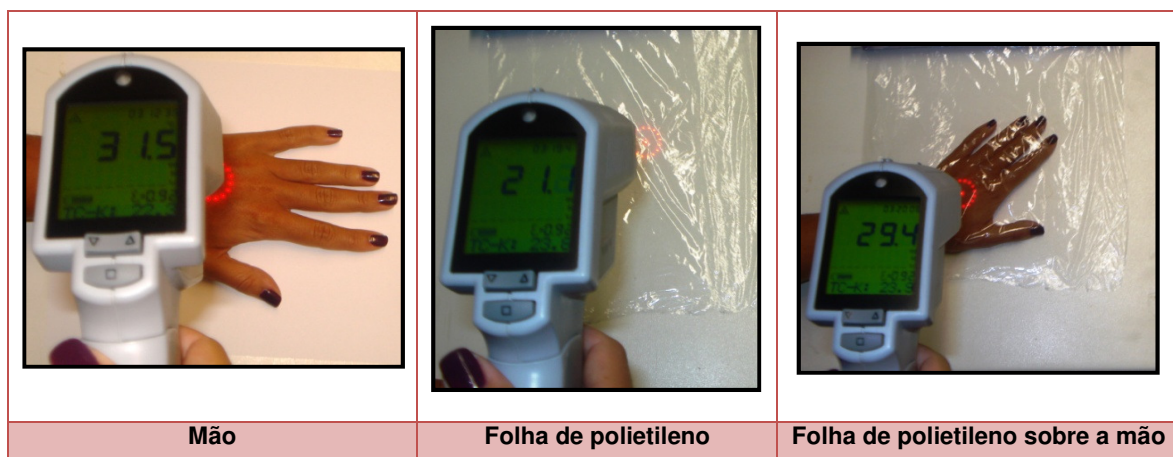
Figura 3.16 - Teste expedito de transparência aos IV de uma folha de polietileno.
