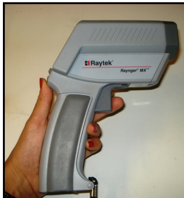
Figura 3.13 - Pirómetro de IV da Raytek.
