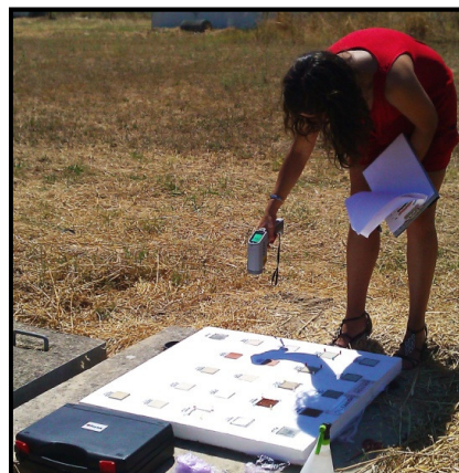
Figura 3.30 - Influência do operador nas medições (sombreamento).
