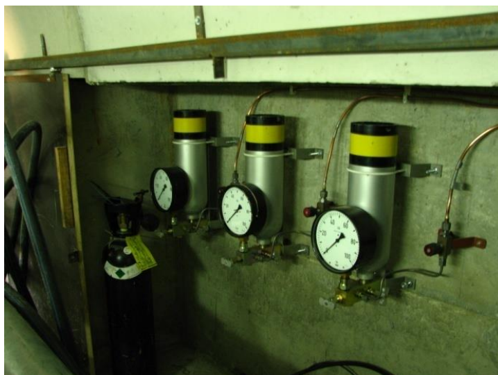
Figura 2.20 – Equipamentos aparentes do sistema de carga de um conjunto de células de fluência da barragem de montante do Baixo Sabor
