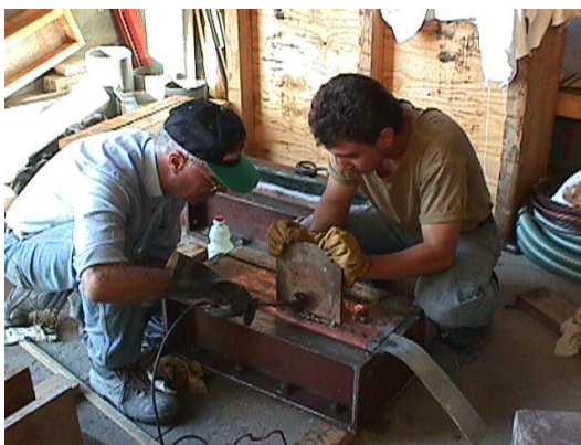
Figura 4.6 – Selagem dos provetes em fresco após moldagem
