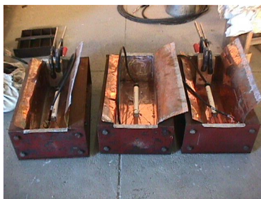
Figura 4.5 – Moldes prismáticos com selagem de cobre e extensómetros de resistência elétrica do tipo Carlson instalados
