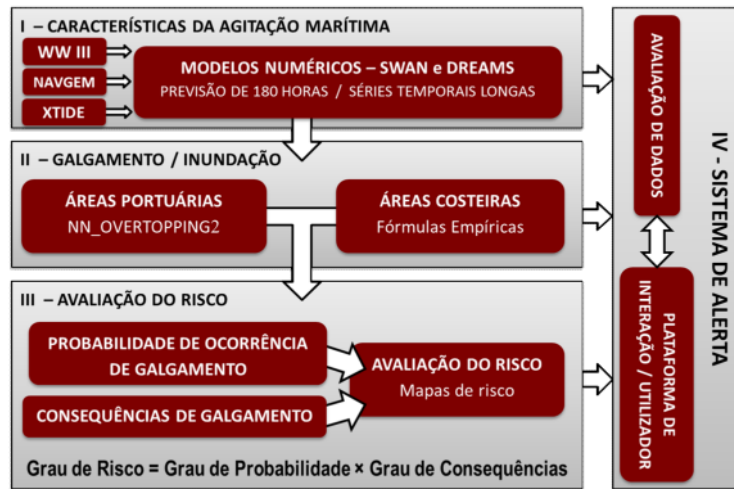
Figura 1. Esquema do Sistema HIDRALERTA.
