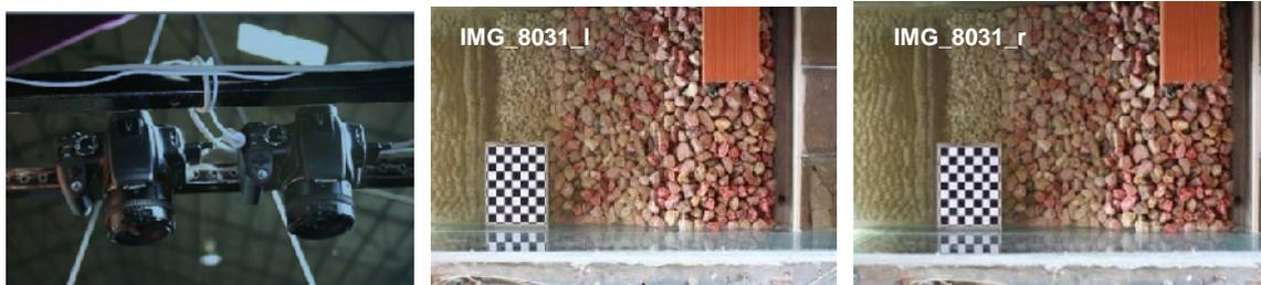
Figura 5. Equipamento fotográfico utilizado e exemplo de um par fotogramétrico obtido durante um levantamento.
