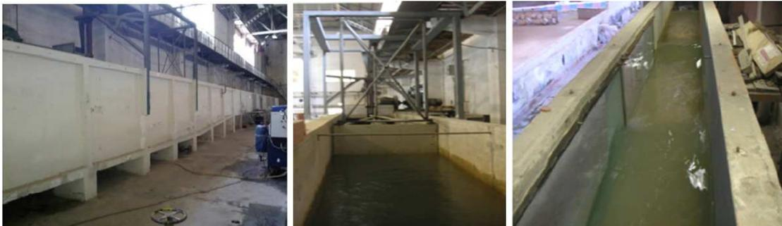
Figura 25 – Vista lateral do canal (à direita), gerador de ondas (no centro) e vista de cima do canal (à direita).
