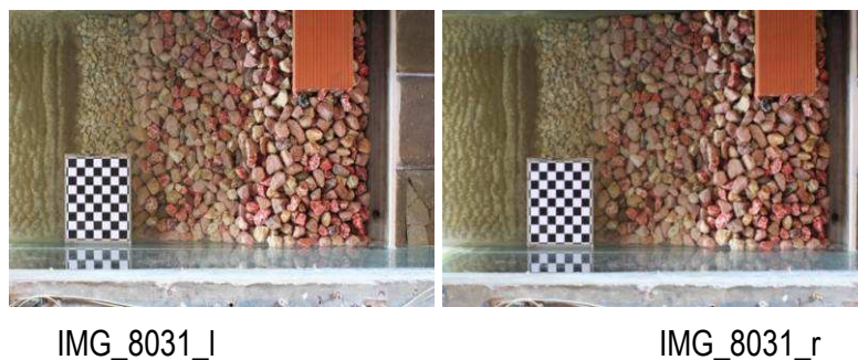
Figura 1 Equipamento fotográfico utilizado e exemplo de um par fotogramétrico obtido durante um levantamento
