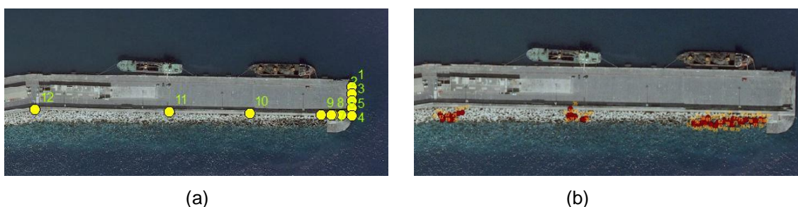
Figura 3 – (a) Distribuição espacial dos pontos de controlo pertencentes à rede de monitorização da Estabilidade Absoluta do Quebramar; (b) Subconjuntos de Tetrápodes (Pereira et al., 2011).
