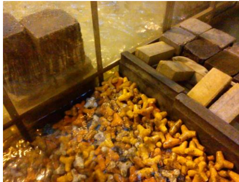
Figura 12 – Inclinação do módulo mais afastado da superestrutura evidenciando o impacto da agitação.
