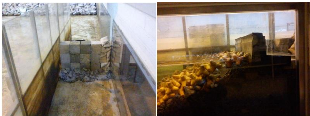
Figura 8 – Fase Inicial e fase final da construção do modelo físico.
