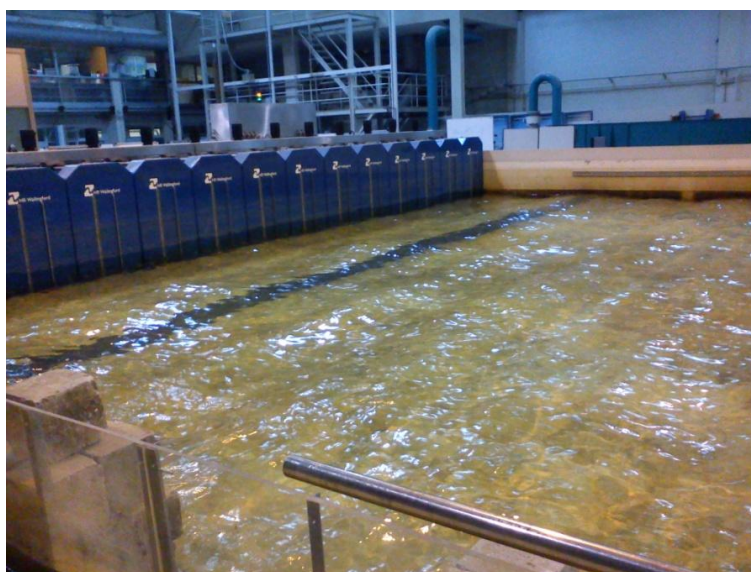
Figura 5 – Sistema de Geração de Agitação. Módulo de pás e tanque de ondas.
