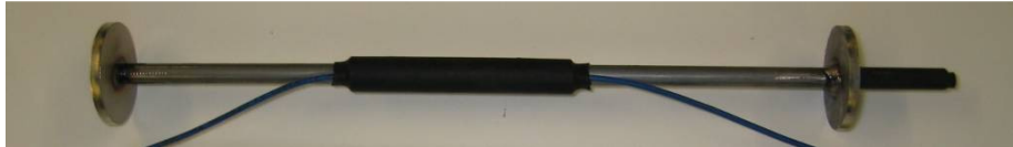
Figura 1. Ilustração do transdutor de deformação em fibra ótica de embeber no betão.
