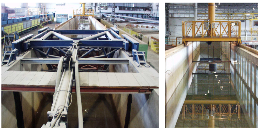
Figura 2 – Vista do bater de ondas irregulares e canal de ondas COI2.
