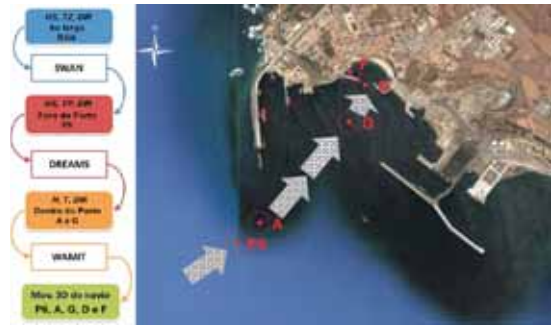
Figura 12 - Esquema de modelação para cálculo dos movimentos do navio e localização dos pontos onde foi aplicado o modelo WAMIT (imagem Google Earth™).
